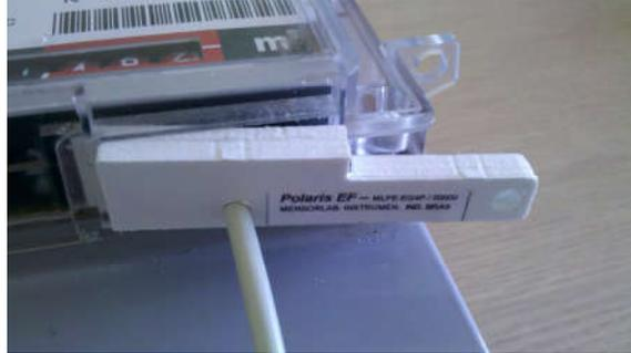
2. Pressione o gerador de pulsos até que o mesmo encaixe completamente no alojamento do medidor de gás;
