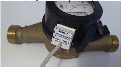
Pressione o gerador de pulsos até que o mesmo fique paralelo à lateral do medidor. ATENÇÃO: TORQUE EXCESSIVO OCASIONARÁ DANOS NÃO COBERTOS PELA GARANTIA;
